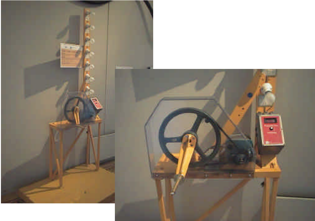
Figur 87.1 Sveivegenerator med 7 lyspærer
